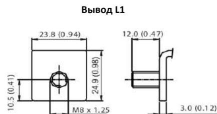
Усилие затяжки: L1 (10Nm±5%)
